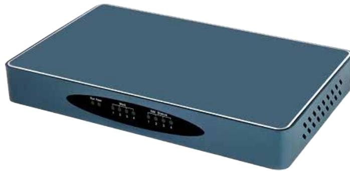
La passerelle OpenVox SWG-M202 est un module permettant, en cas d'alerte, l'envoi et la réception de messages SMS, et d'appels vocaux, afin de diffuser rapidement l'information et les directives aux personnes compétentes. Equipée de 2 emplacements pour cartes SIM, la
