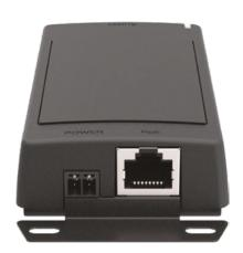
Le bridge sono IP SIP est la solution parfaite pour connecter et associer des systèmes audio analogiques et numériques. Connecté au serveur de notification Smart TAMAT Advance, il vous permet d'utiliser un système de sonorisation existant.
